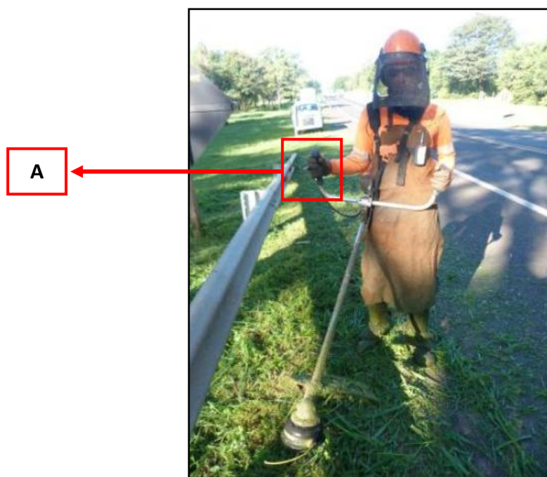
Figura 24 – Localização do acelerômetro na mão do empregado
