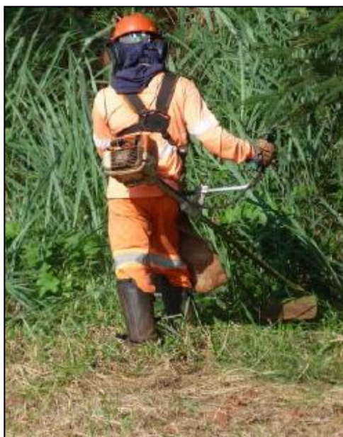
Figura 26 – Operação da roçadeira com ferramenta de corte lâmina de duas pontas
